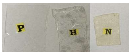
Figura 5. Teste de transparência do filme com nisina e cardamomo.
